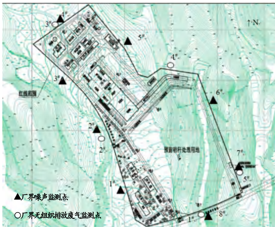
图 7.3-2 厂界无组织废气、敏感点环境空气及噪声监测点位示意图
